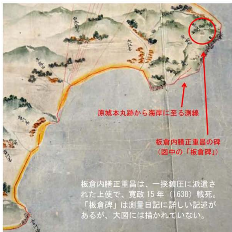
図7 旧島原図（図3）の一部拡大（入江氏撮影） 原城本丸跡から海岸に至る測線および南有馬村吉川名の河口から北に向かう方位線
