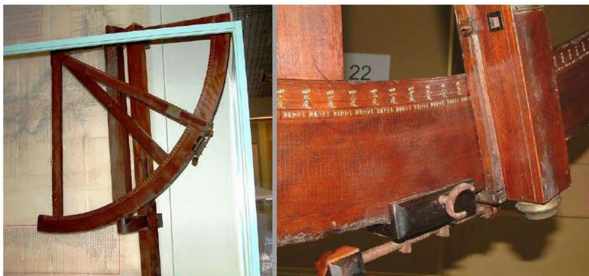
図1. 左は新出の象限儀。右は象限盤の対角斜線目盛と微動ネジ装置部分、及び視準用望遠鏡の接眼部(右下)
