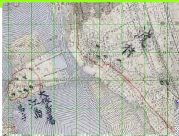
図3 中浦水道付近の重ね合わせ図 (左)と1899(明治32)年測図の旧版 五万分の一地形図「境」(部分)に伊能図 側線を青線で記入した図(下)
