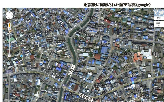
屋根瓦が落ち、ブルーシートで応急措置をした建物が多数みられる。
