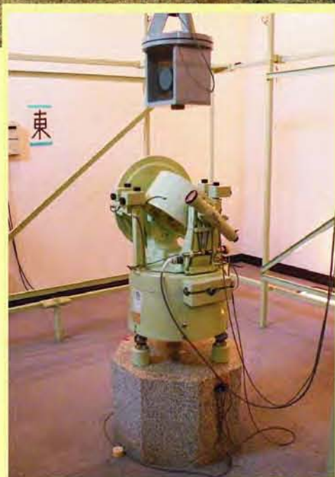
右写真 上部はプロトン磁力計で地球磁場の強さを測定する装置である。 下部は磁気儀で地磁気の向き・方向を測定する装置である。
