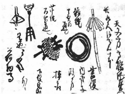
大前家文書（岐阜県歴史資料館蔵）に描かれた測量器具。 右からぼでん、鯨縄、芋縄、方位盤、象限儀
