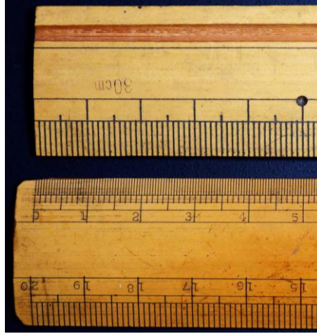
図5 物差しの目盛り 上：最小目盛り1mmの物差し 下：最小目盛り0.5mmの物差し
